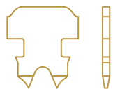
Contato Simples (Cabo Sólido)
